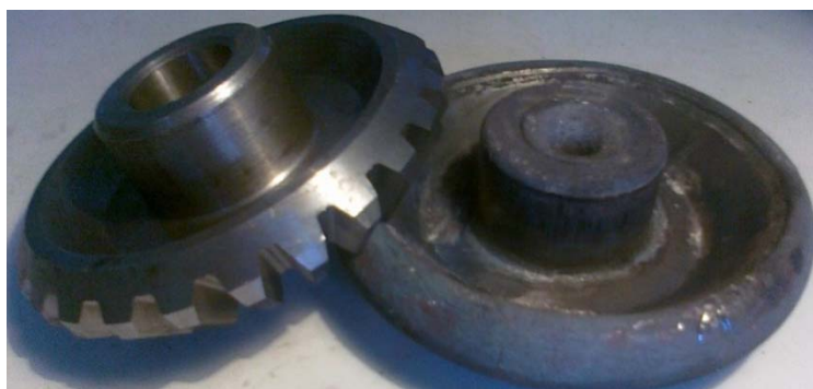
Рис. 1. Шестерня и поковка шестерни
